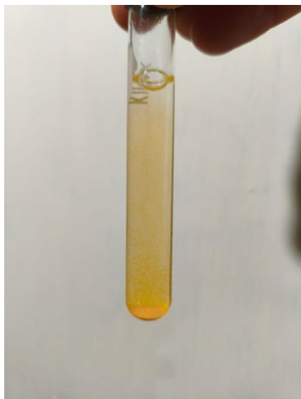
Figura 1. Reacción característica del plomo: lluvia de oro. Imagen original de autor.
