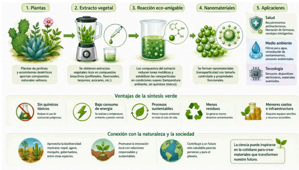
Figura 1. Proceso en el que extractos de plantas se utilizan para la formación de nanomateriales mediante métodos más sustentables. Imagen generada usando IA
